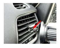
⑤ 車のエアコン吹出口のルーバーの隙間に、取付ユニットの固定 フックを差し込みルーバーにフック先端部が引っ掛けて、 フック調整ダイヤルを回し固定できる長さまで調整します。
