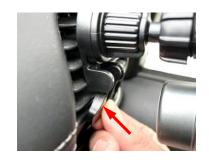
④ 車載取付部の形状に合わせて固定するように、取付ユニットの 角度調整レバーの角度を調整します。
