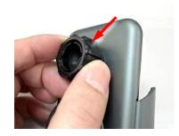
① ワイヤレス充電ユニットに付いているボールジョイント固定用 リングを回して取り外します。
