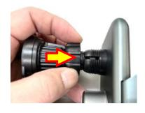
③ 取付ユニットのボールジョイント部をワイヤレス充電ユニットのボールジョイント固定部分にはめ込み、ワイヤレス充電ユニットが動かない程度に、ボールジョイント固定用リングを回して固定します。
